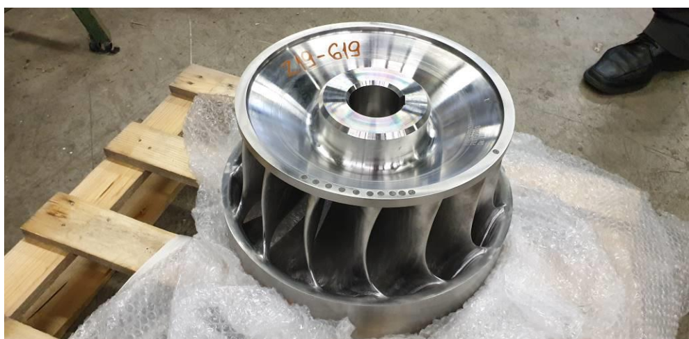
Obnovljena turbina MHE Mavčiče
